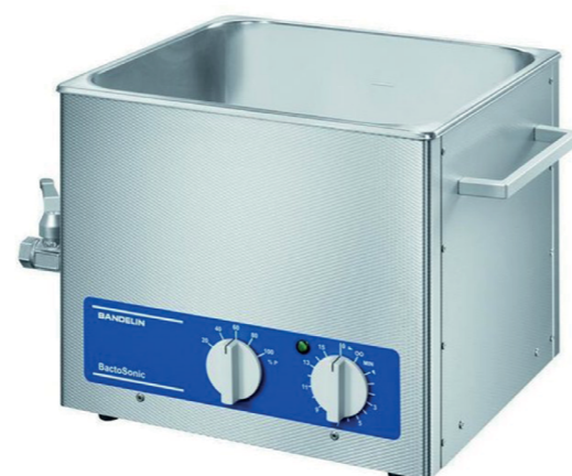
FIGUUR 1: een standaard ultrasoon bad, met temperatuurregeling en timer. (Afbeelding: Bandelin).
